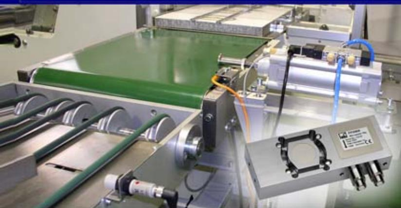
Результат контрольного взвешивания с последующей фильтрацией измеренных значений и выделением массы объекта при помощи специальных алгоритмов, заложенных в электронику и специально разработанных цифровых фильтров.
